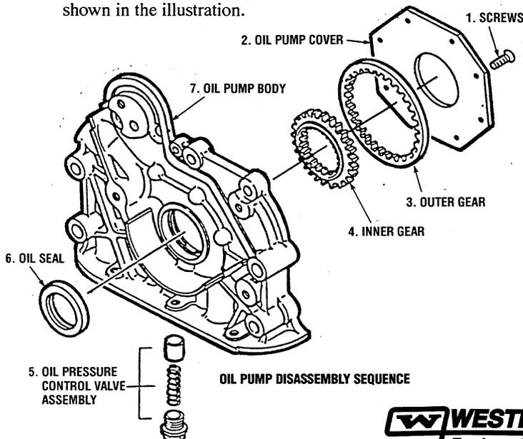
OIL PUMP DISASSEMBLY SEQUENCE
